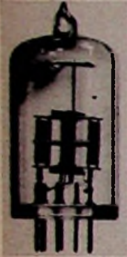
Bild 1. Die Röhre im Gegenlicht. Höhe ohne Pumpstutzen 5 cm
