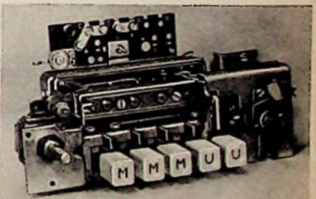
Bild 3. Dieses Bild zeigt die robuste Ausführung des Drucktastensatzes im Telefunken-Autoempfänger II D 61 (II D 11). Darüber ist die Umschaltplatte für 6- oder 12-Volt-Betrieb sichtbar
